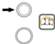
Когда стрела поворачивается за пределы заднего колеса, «индикатор обнаружения задней зоны» мигает с интервалом в 0,5 секунды, и функция движения будет отключена.
