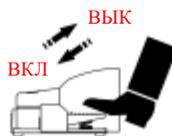
1. Одновременно нажмите «Ножной выключатель» и поверните «Выключатель запуска двигателя/Переключатель аварийного блока питания» влево, двигатель не может быть запущен.
