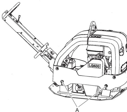
2. Проверить амортизаторы (A) на наличие повреждений.
