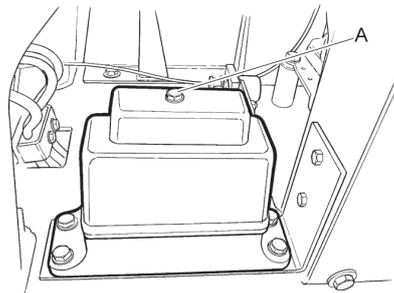
2. С помощью маслозаборного патрубка слить гидравлическое масло из бака.
