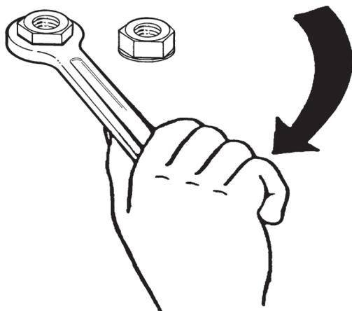
Проверить затяжку винтов, болтов и гаек и при необходимости затянуть их.
