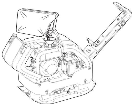
4. Не переполняйте бак. Из-за перемещения топлива в баке возможно нахождение топлива на уровне выше крышки бака, что может привести к утечке топлива при открытой крышке топливного бака. Этого можно избежать только если машина наклонена, а крышка бака является на высшей точке топливного бака.
