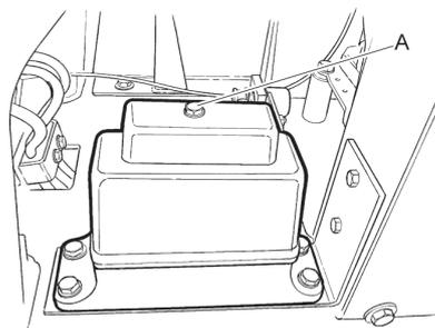
2. Долить гидравлическое масло при необходимости, см. раздел «Гидравлическая система, замена гидравлического масла».
