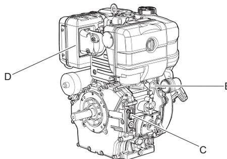
4. Залить моторное масло согласно спецификациям до максимальной отметки на щупе (Е).
