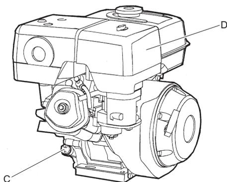
4. Залить моторное масло до максимальной отметки на щупе (С).
